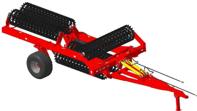
**Назначение:** предпосевное и послепосевное прикатывание почвы, дробление комьев, разрушение почвенной корки, выравнивание поверхности поля при возделывании сахарной свёклы, рапса, зерновых, овощных и других сельскохозяйственных культур.
