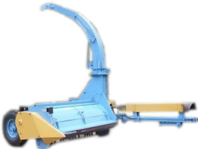
**Предназначен** для одновременного скашивания зеленых сеяных и дикорастущих трав, кукурузы и других силосуемых культур высотой до 1.5 м, измельчения и погрузки на транспортные средства, а так же для уборки картофельной ботвы.
