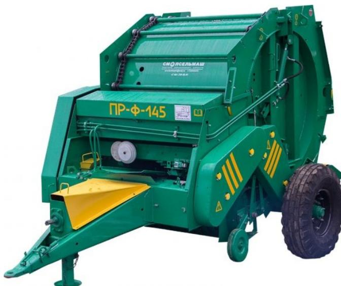
**Назначение:** подбор и прессование в рулоны сена естественных и сеяных трав, подвяленной травы, соломы с последующей обмоткой рулона полипропиленовым шпагатом. Имеют прессующий механизм цепочно-планчатого типа.
